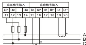
三相三线电流经CT输入 电压直接输入
